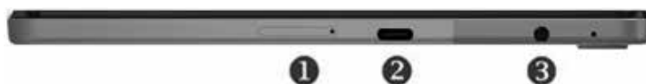
Obrázok 6 – Príklady umiestnenia vstupov a výstupov na tablete: 1 – vstup na SIM/ pamäťovú kartu, 2 – vstup/výstup USB typ C, 3 – vstup na slúchadlá (*rozloženie vstupov a výstupov na našom tablete sa môže mierne líšiť v závislosti od typu zariadenia)
